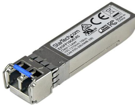
Le modèle EXSFP10GELRS est un module de transceiver à fibre optique compatible avec Juniper EX-SFP-10GE-LR, qui a été conçu, programmé et testé pour fonctionner avec les commutateurs et routeurs de la marque Juniper®. Il fournit une connectivité 10 GbE fiable sur câble à fibre optique pour les réseaux conformes aux spécifications 10GBASE-LR, avec une distance maximale de 10 km.
