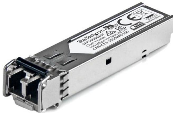
Le SFP100BEXST est un transceiver SFP à fibre optique conforme aux normes MSA qui est conçu, programmé et testé pour fonctionner avec des commutateurs et routeurs 100BASE-EX conformes aux normes MSA. Le module de transceiver SFP prend en charge une distance maximale de 40 km et fournit une connectivité Ethernet 100 Mb fiable via un câblage de fibre optique.
