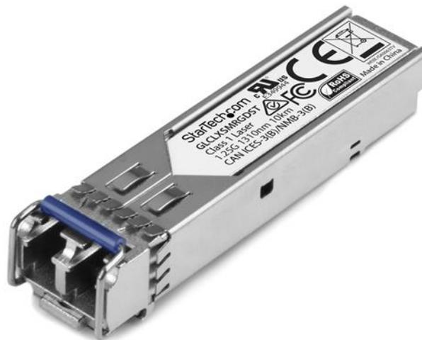
Le modèle GLCLXSMRGDST est un module de transceiver à fibre optique compatible avec Cisco GLC-LX-SM-RGD, qui a été conçu, programmé et testé pour fonctionner avec les commutateurs et routeurs de la marque Cisco®. Il fournit une connectivité 1 GbE fiable sur câble à fibre optique pour les réseaux conformes aux spécifications 1000BASE-LX, avec une distance maximale de 10 km.
