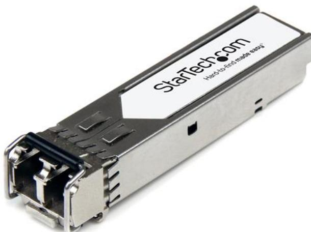
Le SFP-10G-ZR-ST est un module de transceiver SFP+ à fibre optique compatible Cisco SFP-10G-ZR qui a été conçu, programmé et testé pour fonctionner avec des commutateurs et des routeurs de marque Cisco®. Il vous assure une connectivité de 10 GbE par câble en fibre, sur les réseaux compatibles 10GBase-ZR et sur une distance maximale de 80 km.
